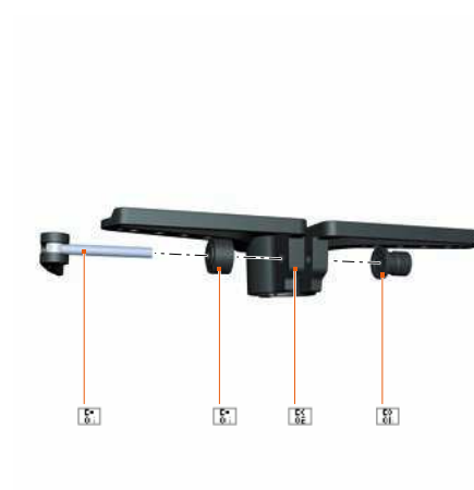
Fig. 55: Snelspanner en kleminrichting stuurdriehoek
