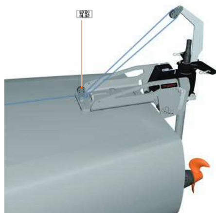
Fig. 24: Système de poulie des modèles 1103 AC
